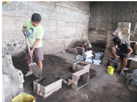
Moulage artisanal de lèches-frites en aluminium
